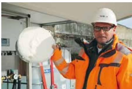
Porenleichtmörtel ist ein vielseitiger Baustoff. Um ihn effizient und prozesssicher herzustellen, hat die Ha-Be Betonchemie GmbH den mobilen Schaumgenerator „SUMO“ entwickelt. Das ist eine betriebsbereite Anlage, die Schaum generiert und dem Mörtel zuführt. Die Heidelberger Beton GmbH setzt in Zukunft auf dieses Anlagensystem.
