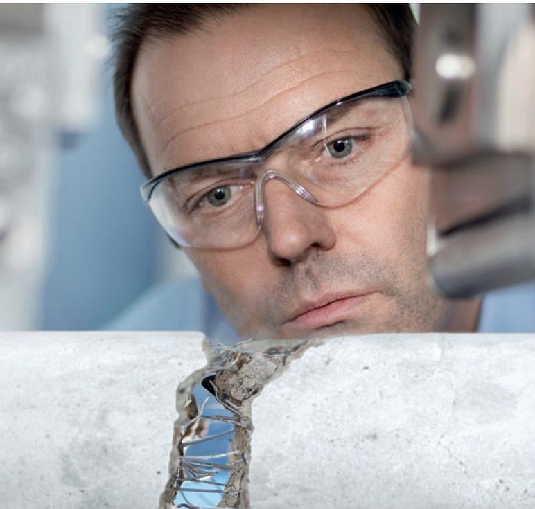
Qualitätskontrolle bei KrampeHarex, Balkenversuch mit Faserbeton
