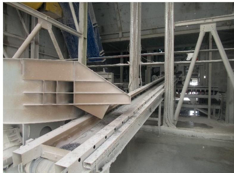
Faserdosiereinheit mit Pufferförderer
